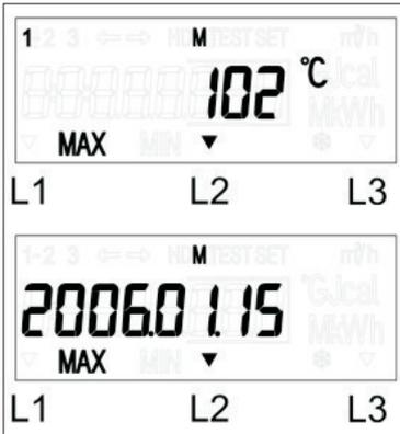
Максимальное значение температуры теплоносителя в подающем трубопроводе, зафиксированное за предыдущий месяц
