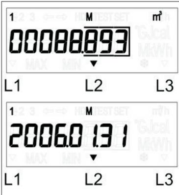
Объем прошедшего теплоносителя через дополнительный внешний счетчик 1 за предыдущий месяц
