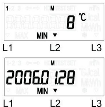
Минимальное значение температуры теплоносителя в подающем трубопроводе, зафиксированное за предыдущий месяц
