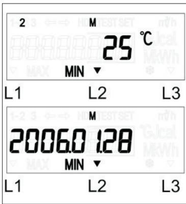
Минимальное значение температуры теплоносителя в обратном трубопроводе, зафиксированное за предыдущий месяц
