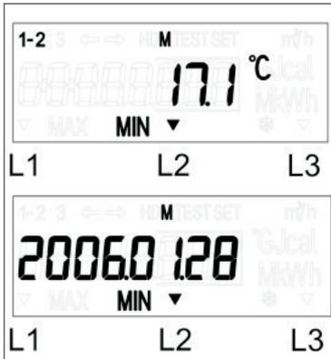
Минимальное значение разности температур теплоносителя, зафиксированное за предыдущий месяц
